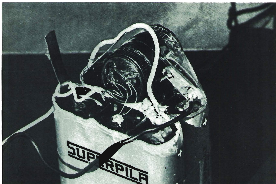
Particolare dei fili delle lampadine (si noti la connessione in parallelo).
